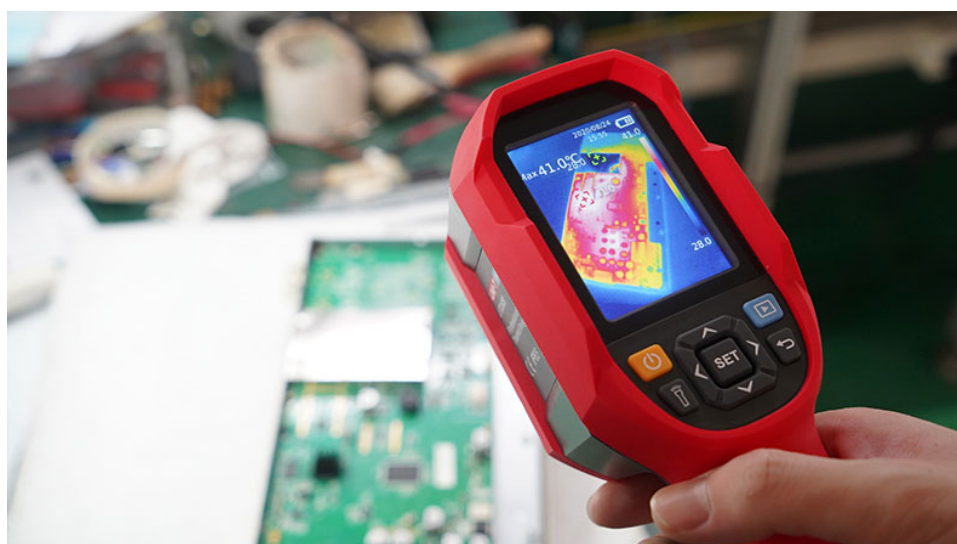
Inspekcja i kontrola płytek drukowanych PCB z elektroniką
